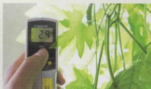
物体から放射される赤外線や可視光線の強度を測定して、物体の温度を測定する温度計。瞬時に、非接触で測定ができるため、暑いところ探しにピッタリの測定器具。安価なものから高額な器具まで様々ありますが、5000円～1万円前後の商品が一般的です。
